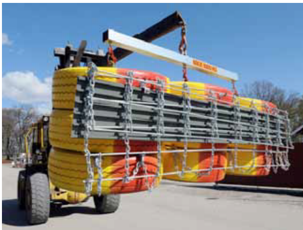
701 1712 Lyftok, CE-märkt Lyftok måste användas när bufferten flyttas med monterat skyltstativ. OBS! Lyftoket får ej sitta kvar på bufferten när den är utställd på vägen.
