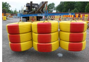
Lyftok måste användas vid transporter.
