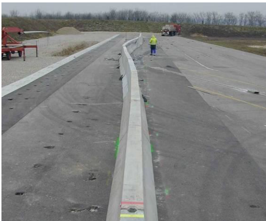
Sammanhållen element kedja efter kollisionstest - DB 100 /6m - K280 - TB 81
