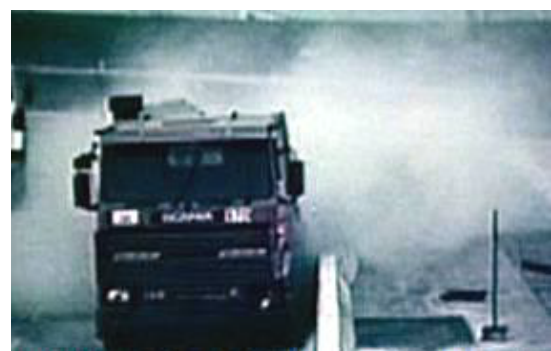
H4b test TB81 (38t HGV, 65km/h, 20° träffvinkel)
